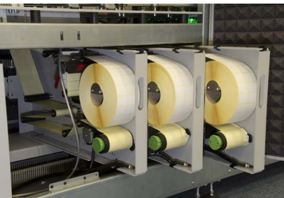
Ein dreifacher Labeler ermöglicht hohe Geschwindigkeiten auch mit Etiketten und den Rollentausch im laufenden Betrieb.
